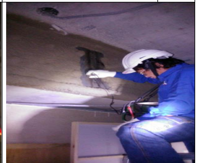
照片 18：本公司查證連梁結構補強鐳道檢 測
