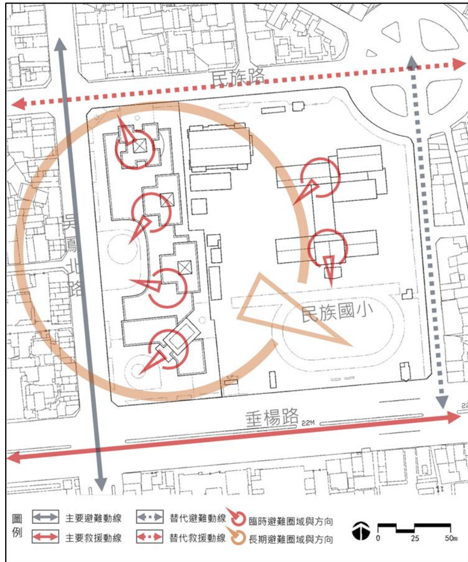
圖4-7 防災系統示意圖
