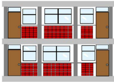
擴柱補強工法示意圖(補強前)
