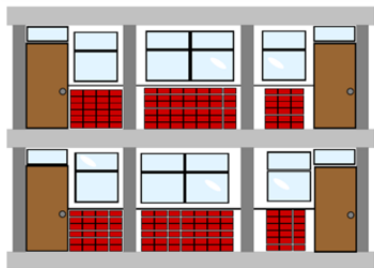
翼牆補強工法示意圖(補強前)
