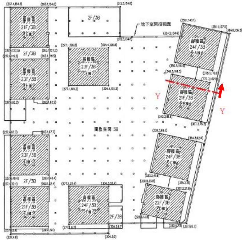
A6-2 區 A、B、C、D棟地下室梁裂縫位置平面示意圖
